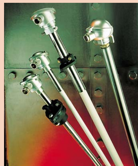
Cannes CADID pour hautes températures, à partir de 500 °C. L'élément sensible, un thermocouple emperlé, est recouvert d'un protecteur métallique ou bien d'une gaine en céramique ou en alumine.
