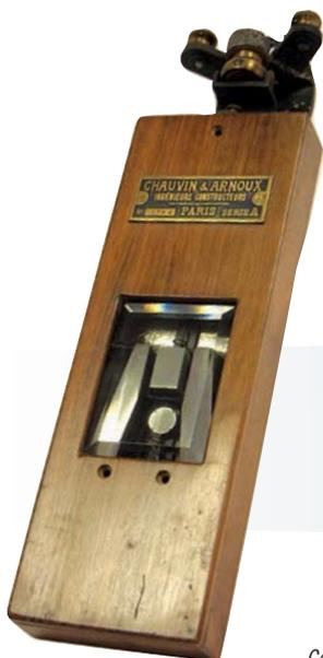
Galvanomètre à réflexion de 1895
