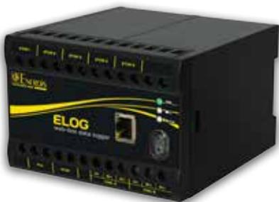
*ELOG est une unité de télérelève automatique, d'enregistrement et de stockage des données énergétiques, climatiques et de process, issues d'appareils communicants sur les réseaux RS485 ModBus, Ethernet ModBusTCP et à sortie impulsions. Les pages web embarquées permettent un accès rapide et intuitif à la programmation du produit et la supervision des données mémorisées (via navigateur web, sur smartphone, tablette, PC, tableur Excel...).*
