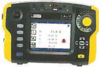
ÖVE/ÖNORM E 8001, NIN/NIV). Alle Funktionen können direkt über den Drehschalter auf der Vorderseite des Gerätes bedient werden. Dies erleichtert die Handhabung mit Schutzhandschuhen. Die Anschlussbuchsen sind farbcodiert, um fehlerhafte Anschlüsse zu vermeiden. Eine mehrsprachige Kontexthilfe führt den Anwender durch die Bedienschritte. Die Modelle C.A 6116N und C.A 6117 sind mit einem zusätzlichen Autonomie bietenden Lithium-Ionen-Akku ausgestattet. Die
