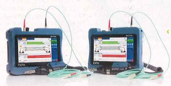
6 Bild 3: Mit dem Testset von Exfo erhält man einen schnellen Überblick über das Dämpfungsverhalten in Glasfaserstrecken
