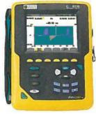
Für die Dimensionierung von elektrischen Anlagen und für die Erkennung von Schaltfehlern verfügt der C.A 8336 über die Funktionen Inrush und Truelnrush. Das Gerät verfügt über vier Messkanäle für Spannungen und vier für Ströme und er erfasst und speichert gleichzeitig sämtliche gemessenen Parameter, die Transienten, die Alarme und die Wellenformen. Beim Anschluss erkennt das Gerät automatisch die verwendeten Stromwandlern. Es können sogar unterschiedliche Stromwandler gleichzeitig verwendet.
