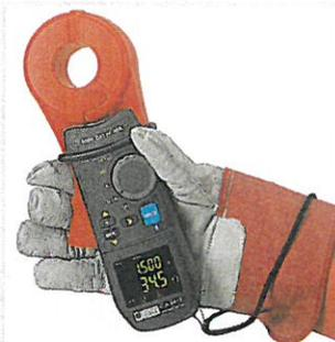
gen oder bei Fundamentern lässt sich die Niedrigkeit der Erdleiter bequem prüfen, da die Prüfzangen auch kleinste Werte anzeigen. Die Einsatzmöglichkeiten sind vielfältig.
