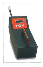
Der schnurlose, akkubetriebene SF<sub>6</sub>-LeakSpy ist eine richtige »Spürnase«. Mit dem Schnüffelgerät werden selbst kleinste SF<sub>6</sub>-Leckagen bis zu 3 g/Jahr detektiert. Das Gerät misst die Konzentration von SF<sub>6</sub> in Luft mittels eines nicht-dispersiven Infrarot-Sensors ppmv-genau und zeigt den Wert auf einem Grafik-Display
