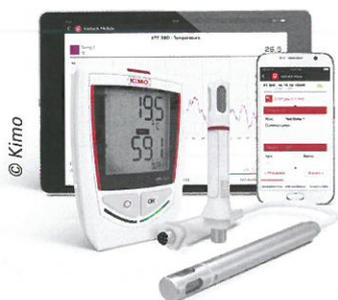
*Le Kistock de Kimo : une connectivité simple et efficace pour tous vos enregistrements de température, humidité, tension, courant et impulsion.*
