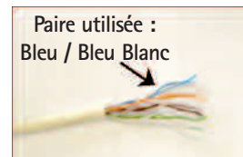
Paire utilisée : Bleu / Bleu Blanc Câble USB 4 paires torsadées Catégorie 5 Impédance 100 Ω
