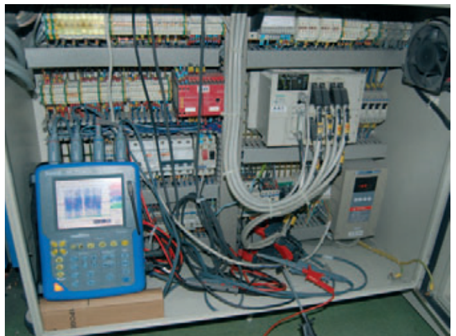
Image 2 - Le Scopix est installé dans l'armoire de commande du poste et mesure les tensions et courants MLI.
