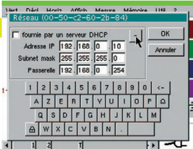
Ecran2 - Définition complète d'une configuration réseau Ethernet.
