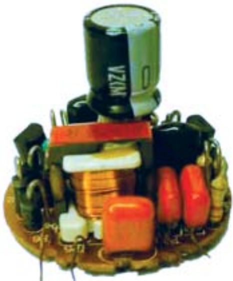
Exemple de ballast électronique d'une lampe à économie d'énergie 8 W, 230V-240V sans allumage progressif.
