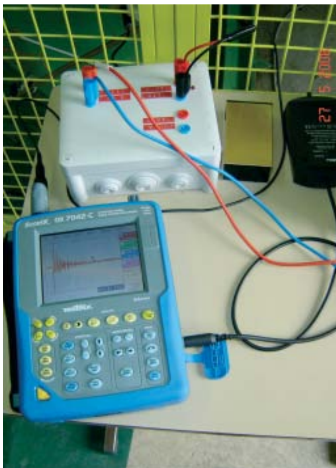
Accéléromètre collé sur un brin de la courroie et raccordé à l'oscilloscope SCOPIX OX7042C
