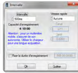
Edinim, MTX3292B/MTX3293B üzerinde minimum 0,2 s adım
