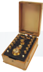
Bu 1900 yılı kalibrasyon potansiyometresi, standart bir pil ve yukarıda gösterildiği şekilde, bir galvanometre ile birlikte kullanılıyordu. Fiyatı: 195 franc!
