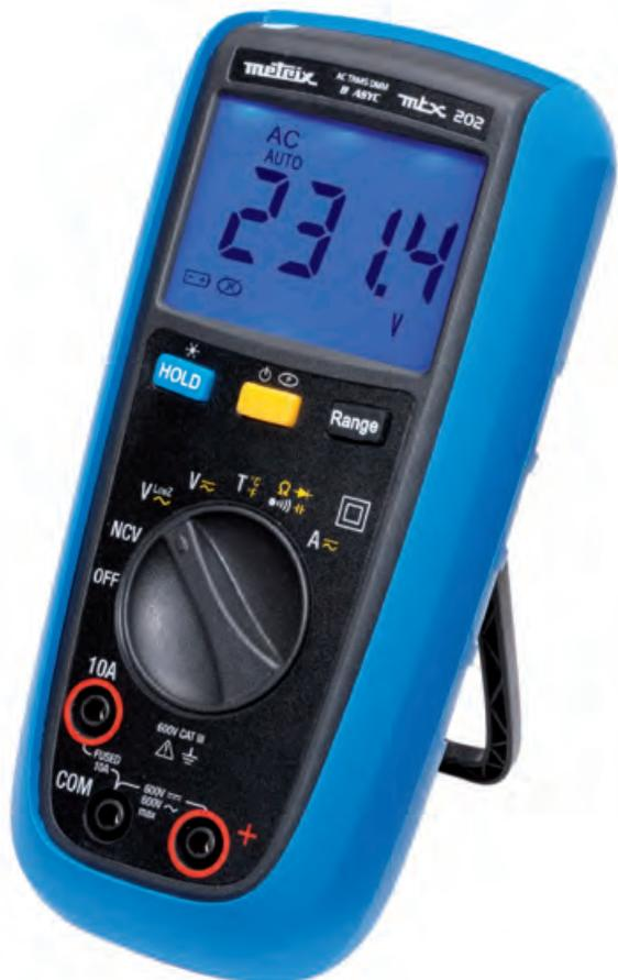
Une gamme de 2 multimètres TRMS AC et de 1 multimètre TRMS AC+DC simples, basiques à affichage numérique pour mesure sur des réseaux électriques, installations jusqu'à 600 V CAT III. Ces multimètres sont des appareils de mesure professionnelle d'usage général ou « tout usage ». Ce sont les meilleurs pour un usage quotidien requérant la mesure TRMS, la précision de la mesure, la robustesse et la fiabilité d'un appareil terrain.
