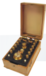
Deze ijkingpotentiometer uit 1900 werd gebruikt met een normaalelement en een galvanometer zoals die hierboven getoond wordt. Zijn prijs: 195 Franse frank!
