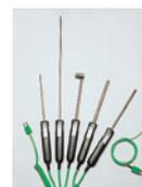
Gamme de sondes thermocouple K pour mesure d'ambiance, de surface ou d'immersion.
