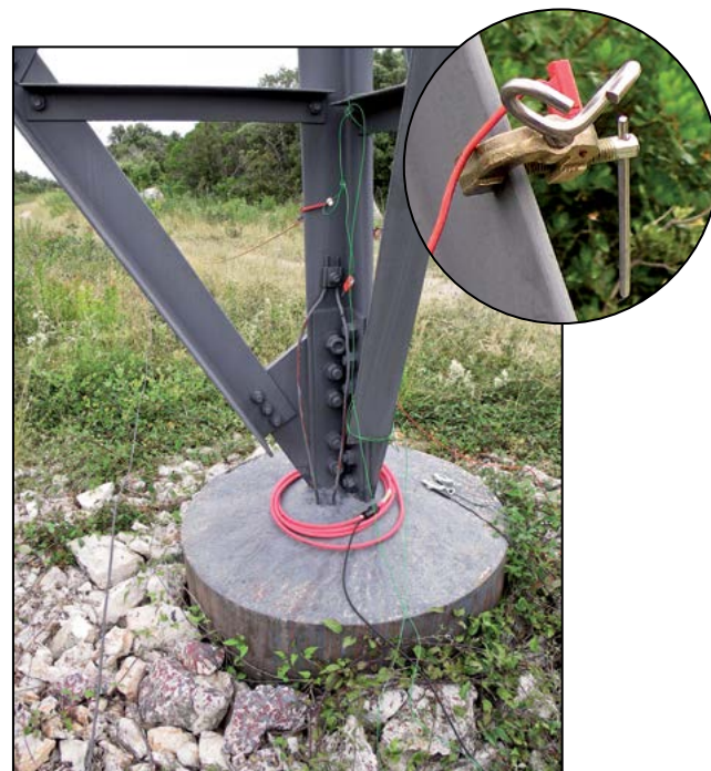
L'utilisation de capteurs AmpFLEX™ offre une grande souplesse vis à vis de la configuration du pylône
