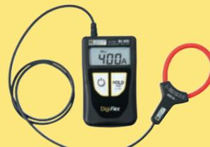
Ampèremètre à capteur flexible
