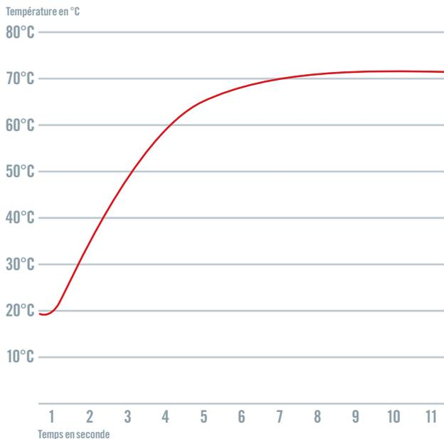
En fonction du type de soudure chaude réalisées, les temps de réponse caractéristiques que l'on peut obtenir sont indiqués ci-dessous :
