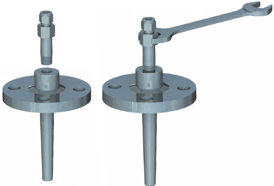
Mettre en place l'extension basse sur le puits thermométrique.
