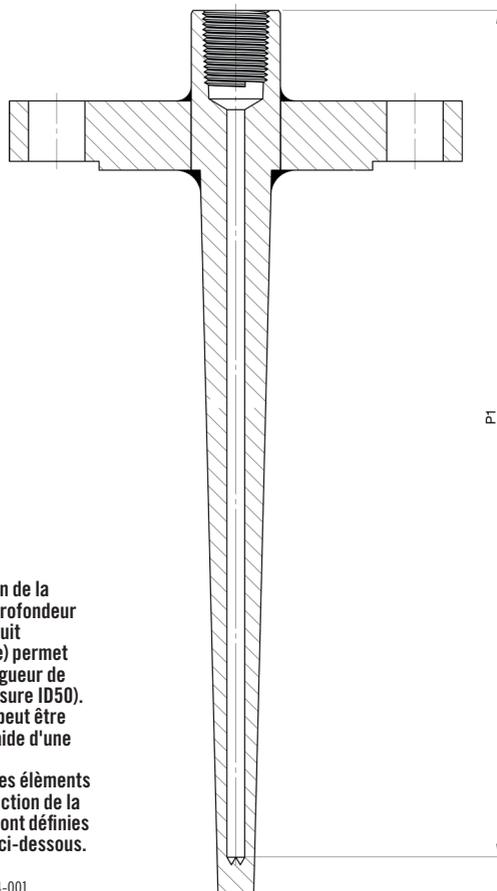
La détermination de la dimension P1 (profondeur de perçage du puits thermométrique) permet de choisir la longueur de l'élément de mesure ID50). Cette longueur peut être déterminée à l'aide d'une pige\*. Les longueurs des éléments sensibles en fonction de la profondeur P1 sont définies dans le tableau ci-dessous.
