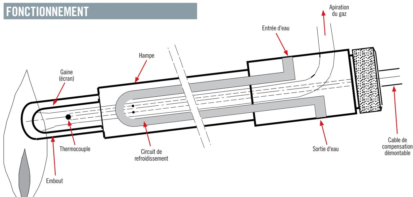
La flamme ou les fumées sont aspirées dans le capteur à l'aide d'une pompe, cette aspiration facilite l'échange de température par convection entre le thermocouple et le gaz. Un thermocouple mesure la température au point chaud. Le coefficient d'efficacité, est déterminé "in situ". Il permet d'obtenir la valeur réelle de la température du gaz prélevé par correction de l'influence de l'aspiration nominale choisie.
