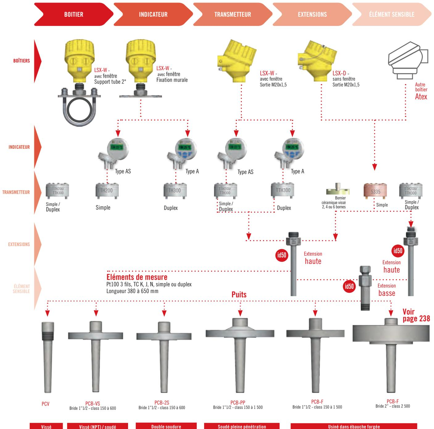
Pensez aussi à protéger vos capteurs de température, de la pression excessive, de la vélocité de la matière et de la corrosion avec nos puits thermométriques (voir page 238)
