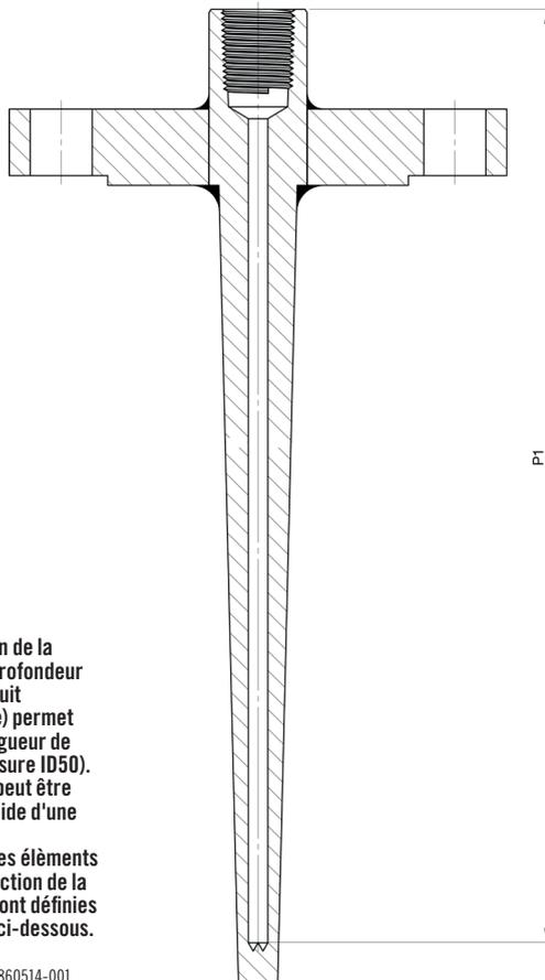
La détermination de la dimension P1 (profondeur de perçage du puits thermométrique) permet de choisir la longueur de l'élément de mesure ID50). Cette longueur peut être déterminée à l'aide d'une pige.
