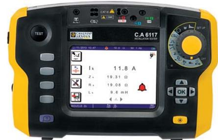
Avec un niveau de sécurité électrique de 600 V CAT III, les contrôleurs sont adaptés à tout types de régimes de neutre (TT, TN, IT). Ils permettent de réaliser le contrôle électrique initial d'une installation neuve ou après rénovation, l'intervention et le dépannage sur une installation...
