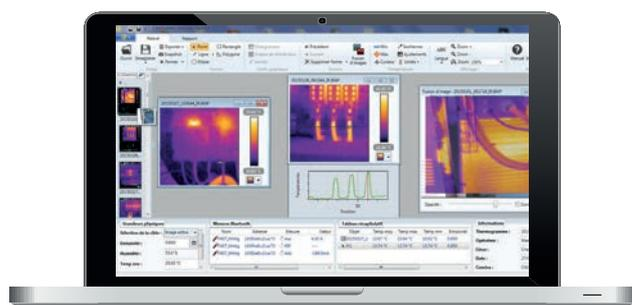
**Tablette dei risultati con visualizzazione automatica rapida di tutte le informazioni/strumenti di analisi del termogramma.**
