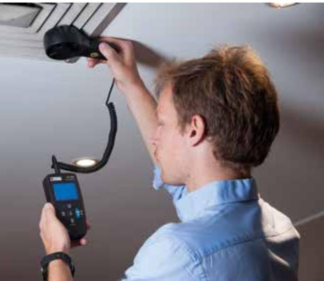
Esempio di misurazione con un termoanemometro CA 1227
