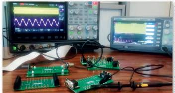
Ein LX1600-PC oder ein DOX3000 ermöglichen die Dekodierung der wichtigsten Feldbus-Typen.
