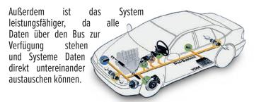
Das Bild unten zeigt eine mögliche Konfiguration der in einem Fahrzeug verlegten Feldbusse. Der CAN-Bus ist in zwei Bereiche unterteilt: einen Bus für die Steuerung des Antriebs und der Sicherheitssysteme, der andere für die »Komfort«-Einrichtungen. Der LIN-Bus bildet eine Untereinheit im CAN-Bus. Der MOST-Bus schließlich verbindet die Audio- und Video-Systeme im Auto.
