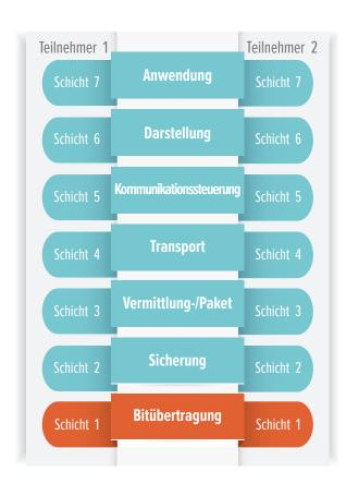
Die International Organisation for Standardization (ISO) hat unterschiedliche Netzarchitekturen untersucht. Sie hat daraufhin ein Referenzmodell mit Schichten entwickelt, mit dem sich Netzwerke zur Kommunikation verschiedener Systeme untereinander entwickeln lassen (Interoperabilität). Das OSI-Referenzmodell wurde 1984 veröffentlicht. Es enthält sieben Schichten, beginnend mit der physikalischen Bitübertragung bis hin zur Verarbeitung der Daten.
