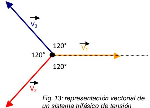
Fig. 13: representación vectorial de un sistema trifásico de tensión
