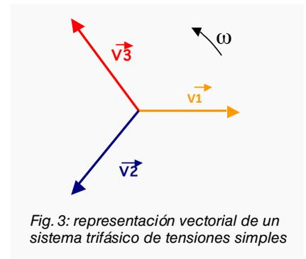
Fig. 3: representación vectorial de un sistema trifásico de tensiones simples
