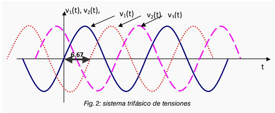
Fig. 2: sistema trifásico de tensiones
