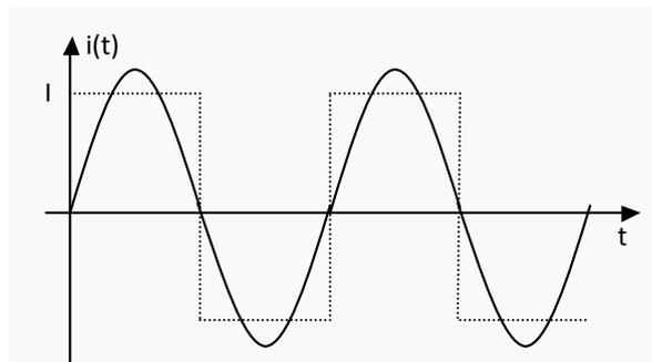
Fig. 9:  $i(t)$  representada por su componente fundamental
