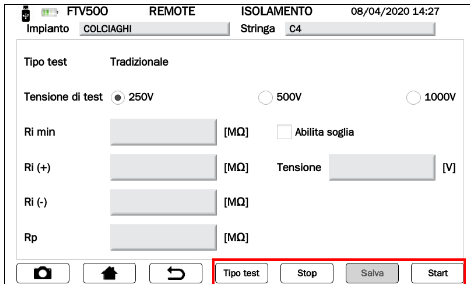
Figura 14.7.5-6 Schermata misura Start Isolamento
