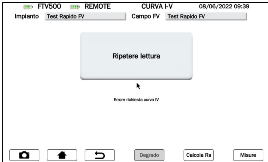
Figura 14.7.3-10 b Schermata di errore: invertire i poli della stringa/modulo per effettuare la misura
