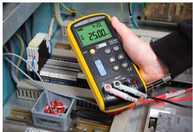
Calibrateur de signaux de process courant et tension
